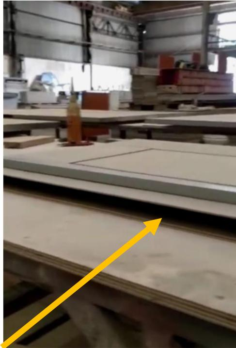
Gambar 9. Lubang daun pintu untuk memasukan beton
