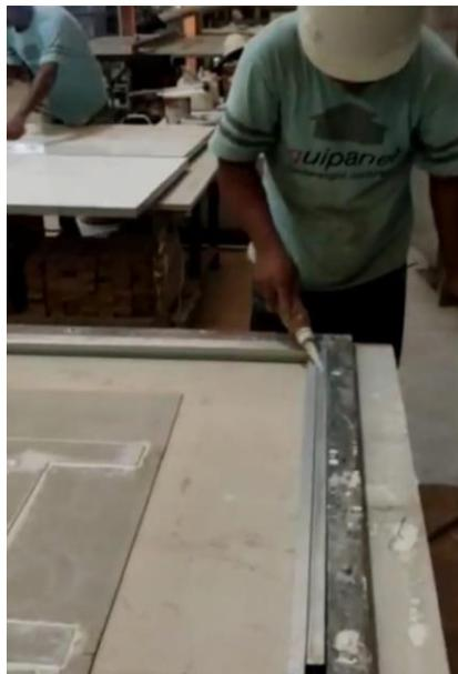
Gambar 6. Proses pemasangan metal furing pada kalsiboard
