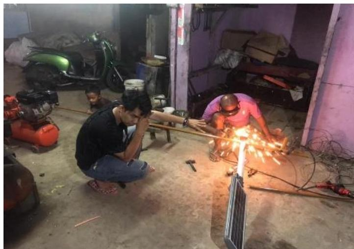
Gambar 6. Proses pengelasan/febrikasi ulang dudukan lampu solar cell
